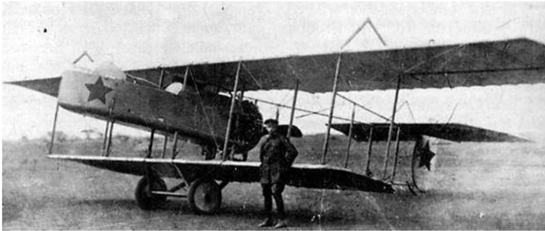
Рис. 4. Самолет «Фарман-30», распространенный во время Гражданской войны тип летательного аппарата, как у красных, так и у белых. Их строил завод «Дукс», выпустивший за 1916 – 1921 годы 400 машин. По оценке летчиков эти самолеты русского производства по своим качествам, особенно по прочности, заметно превосходили французские прототипы. Скорость – 136 км/час, посадочная – 60 км/час, потолок – 4500 м, продолжительность полета до 4 часов.
