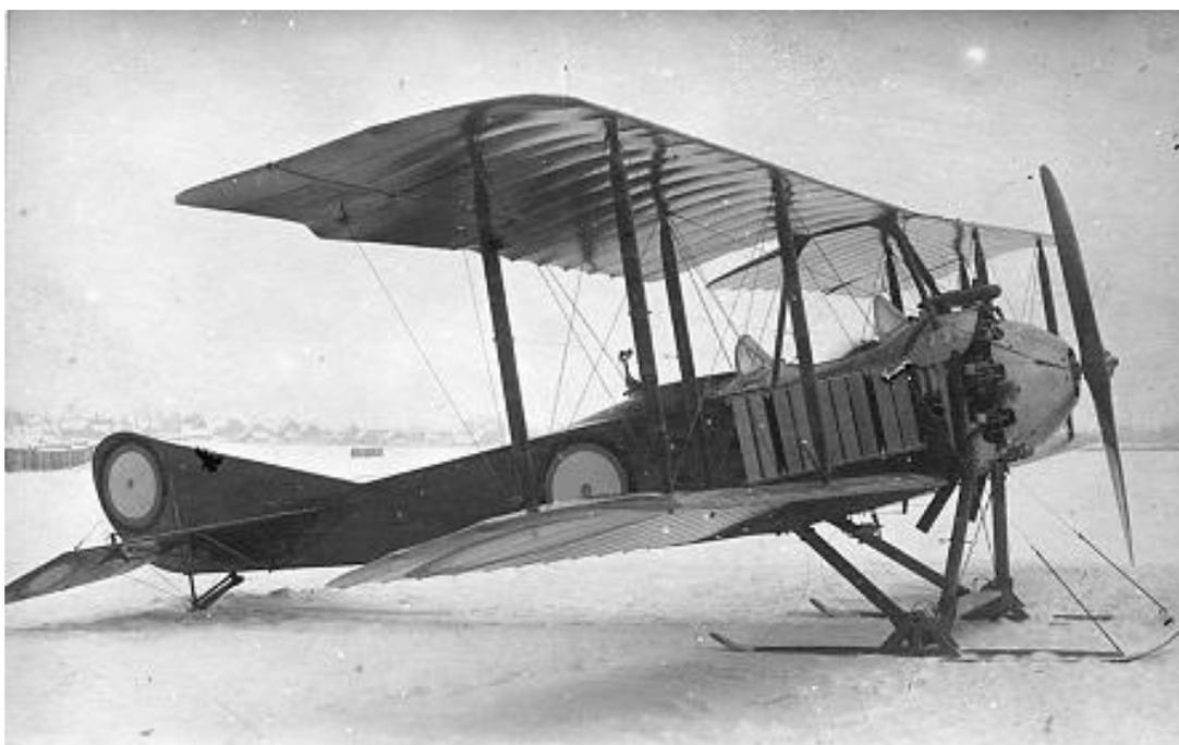
Рис. 13. Разведчик и легкий бомбардировщик Лебедь 12 – занимал видное место среди русских самолетов времен Первой Мировой войны, поскольку стоявший на нем двигатель Salmson мощностью 150 л. с. был единственный в России двигатель такой мощности, изготовлявшийся в сотнях экземпляров, освоенный и надежный. Максимальная скорость – 135 км/ч, крейсерская – 118 км/ч, продолжительность полета – 3 ч, скороподъемность – 125 м/мин, практический потолок – 3500 м, экипаж – 2 чел.
