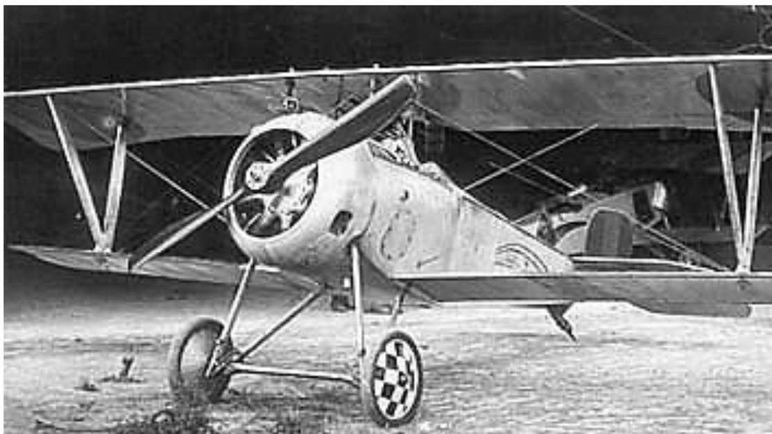
Рис. 2. Истребитель Ньюпор-23 представляет собой версию истребителя Ньюпоре-17. Максимальная скорость – 165 км/ч, крейсерская – 152 км/ч, практическая дальность – 250 км, максимальная скороподъемность – 205 м/мин, практический потолок – 5350 м, Экипаж – 1 чел, вооружение: 7,7-мм пулеметы Vickers и/ или Lewis. Оснащался двигателем Le Rhone 9Jb мощностью 120 л. с. Масса пустого самолета – 375 кг, нормальная взлетная – 560 кг. На фотографии самолет изображен на фоне входа в брезентовый ангар
