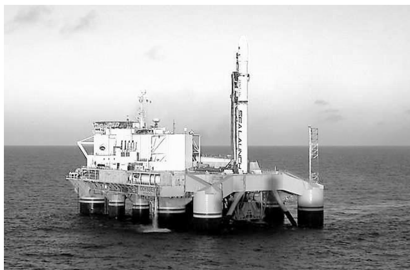
Рис.1. Стартовая плавучая платформа Odyssey в стартовом (полупогруженном) положении с установленной на ней РН «Зенит-3SL»
