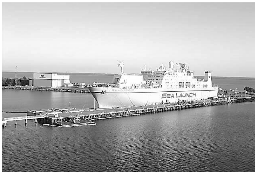
Рис. 3. Сборочно-командное судно Sea Launch Commander на стоянке в Лонг Бич. Страна регистрации судна – Либерия, порт приписки – Монровия, водоизмещение при безопасной рабочей нагрузке – 27 612 т, численность экипажа – 240 чел., максимальная скорость – 21 узел.
