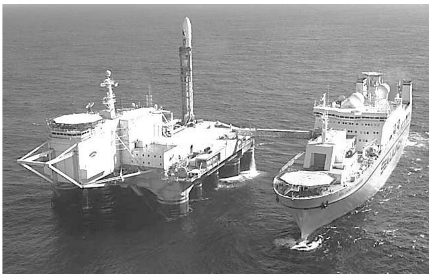
Рис. 5. Взаимодействия СКС и плавучей платформы Odyssey в процессе подготовки старта РН «Зенит-3SL», хорошо виден раздвижной переходной трап, развернутый с борта СКС
