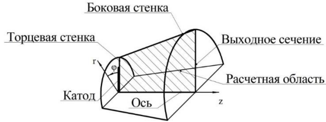
Рис. 2. Область ускорения плазмы
