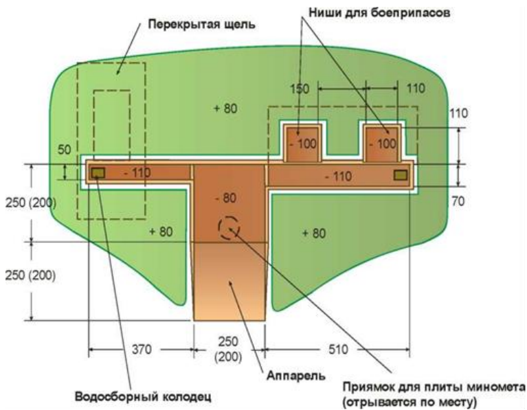
Рис. 3.12. Окоп для 120 (82)-мм миномета (объем вынутого грунта 19 (15) м 3 , трудозатраты окопа (без щели) 24 (18) чел./ч)
