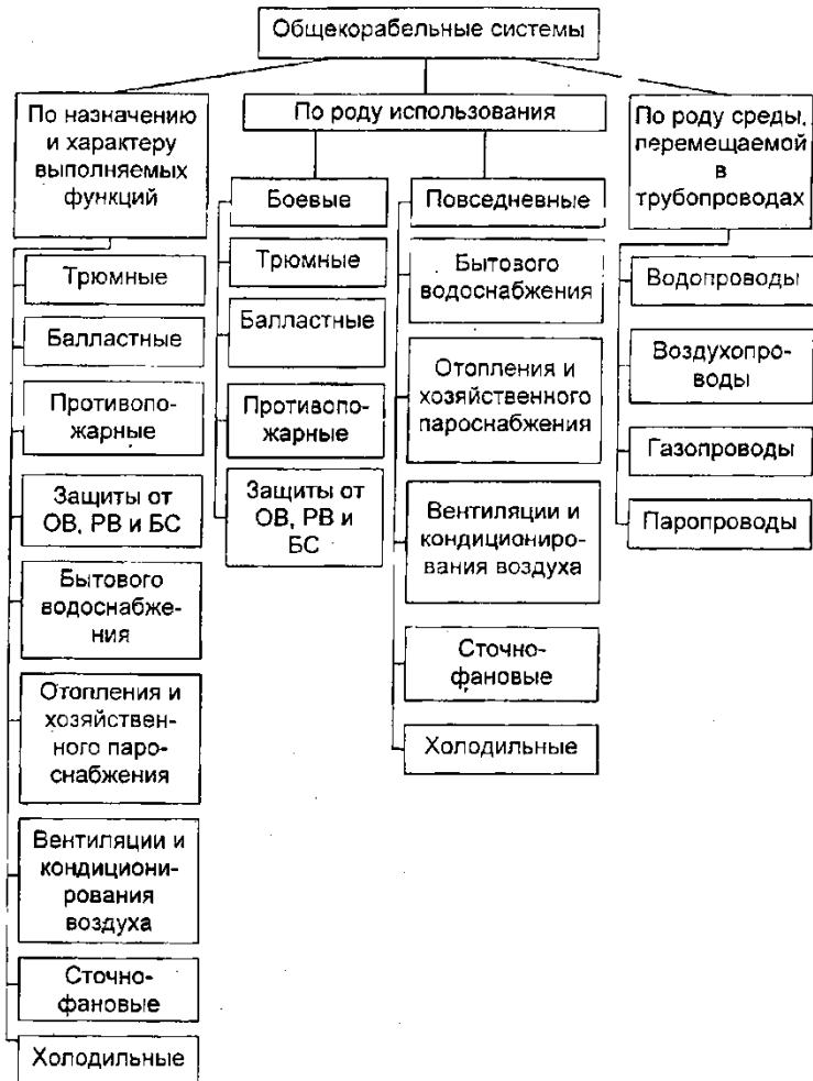
Рис. 5.3. Классификация общекорабельных систем
