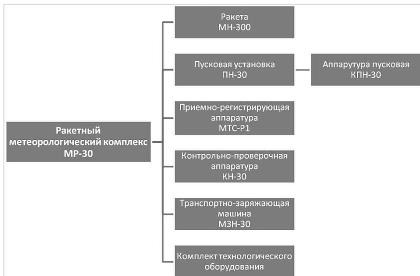
Рис. 4. Структура метеорологического комплекса МР-30. НПО «Тайфун».
