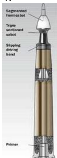
Рис. 1.4. 40 мм снаряд 40 APFSDS-T Mk II IM фирмы Bofors Defence AB
