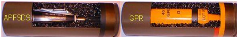
Рис. 1.1. Боекомплект к 40-мм к 40-мм артиллерийской системе СТWS в составе выстрела с БОПС (APFSDS-T) и выстрела общего применения с донным взрывателем (GPR-T).
