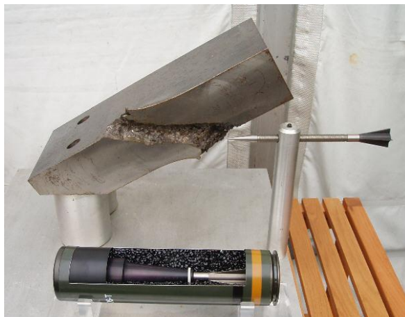
Рис. 1.2. Телескопический выстрел с БОПС к 40-мм артиллерийской системе СТWS и пробитая бронеплита.
