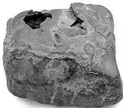
Рис. 6. Угольная мина с отверстием неправильной с наружи формы для снаряжения ее полости взрывчатым веществом. На ее поверхность еще не нанесена камуфляжная пленка из воска и угольных частиц. Обратите внимание на то, что форма бомбы на рисунках отличаются друг от друга
