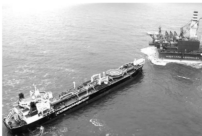
Рис. 6. Танкер-челнок «Михаил Ульянов» готовится принять нефть с помощью системы носового приема груза с морской ледостойкой платформы «Приразломная»
