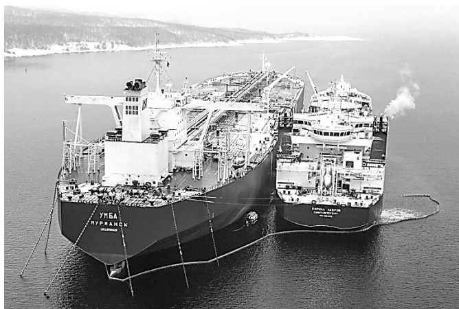
Рис. 5. Частично загруженный (грузовая марка и верхняя часть руля находятся выше уровня воды) танкер-накопитель «Умба» готовится принять нефть с борта танкера-челнока «Кирилл Лавров» на рейде порта Мурманск возле села Белокаменка.
