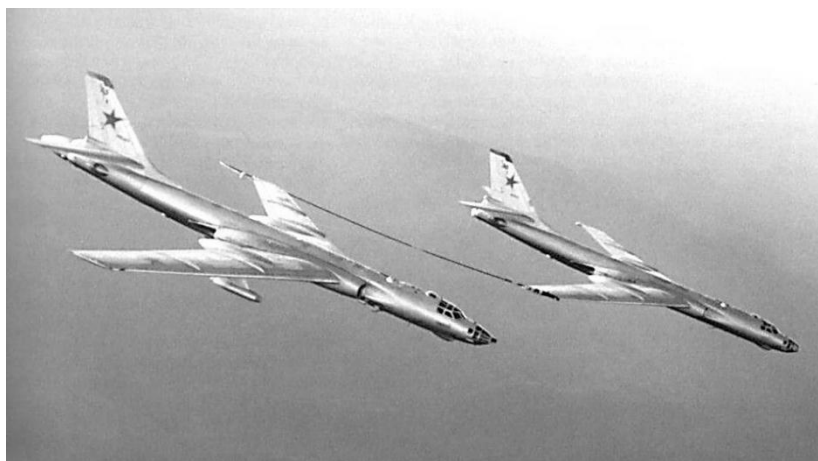
Рис. 3. Дозаправка ТУ-16 методом «с крыла на крыло»
