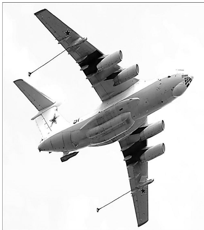
Рис. 5.а. Самолет-заправщик ИЛ-78М. Выпущены заправочные шланги подкрыльевых УПАЗ. В кормовой части фюзеляжа виден ПАЗ-1М
