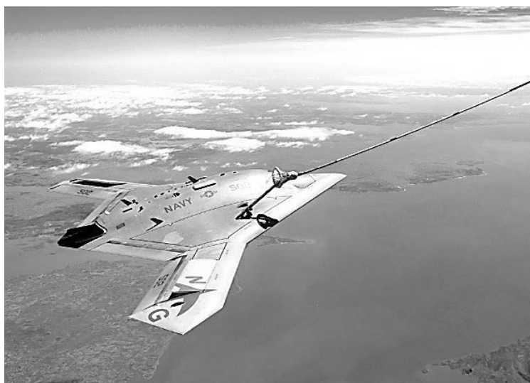
Рис. 7. Топливopриемник на борту БЛА X-47B в автоматическом режиме захватил конус системы дозаправки
