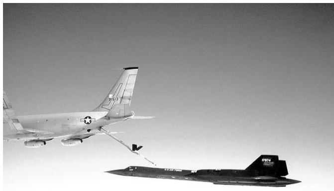
Рис. 1. Boeing KC-135Q заправляет SR-71 по схеме «flying boom»
