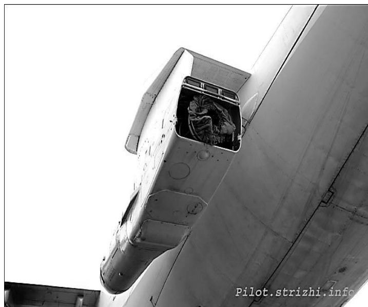
Рис.5.б. ПАЗ-1М на борту самолета-заправщика ИЛ-78М крупным планом
