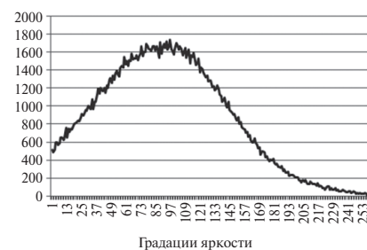
Рисунок 7. График распределения яркостей РЛИ после адаптивной обработки
