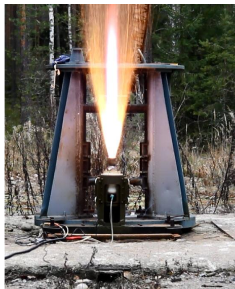
Рис. 2. Полигонный модельный ракетный двигатель, диаметр 100 мм.
