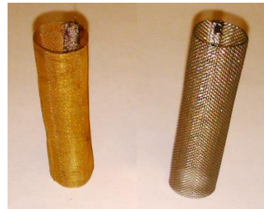
Рис. 4. ТПЭ из латунной и металлической сетки.
