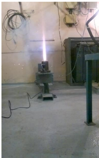
Рис. 1. лабораторный модельный ракетный двигатель, диаметр 30 мм.
