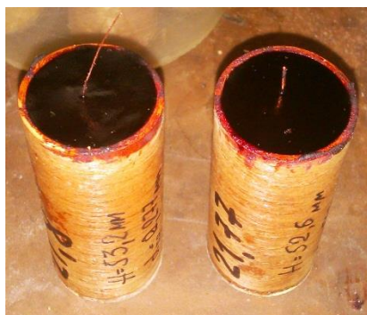
Рис. 6. Капсулы с медной струной по оси заряда.
